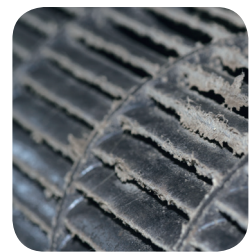
Sisäyksikön puhaltimien siivekkeet 10 vuoden jälkeen ilman pinnoitusta.
