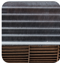
Sisäyksikön lämmönsiirrin 10 vuoden jälkeen ilman pinnoitusta.
