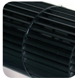
Sisäyksikön puhaltimien siivekkeet 10 vuoden jälkeen ilman pinnoitusta.
